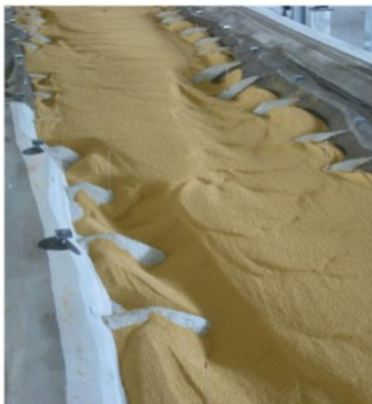
Ilustracja 6-43 Wizualne porównanie wymycia przy główce ostrogi w wariantcie W0 (po lewej) i wariantcie KRC-W1 (po prawej)
