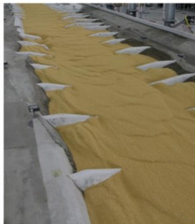
Ilustracja 6-43 Wizualne porównanie wymycia przy główce ostrogi w wariantcie W0 (po lewej) i wariantcie KRC-W1 (po prawej)
