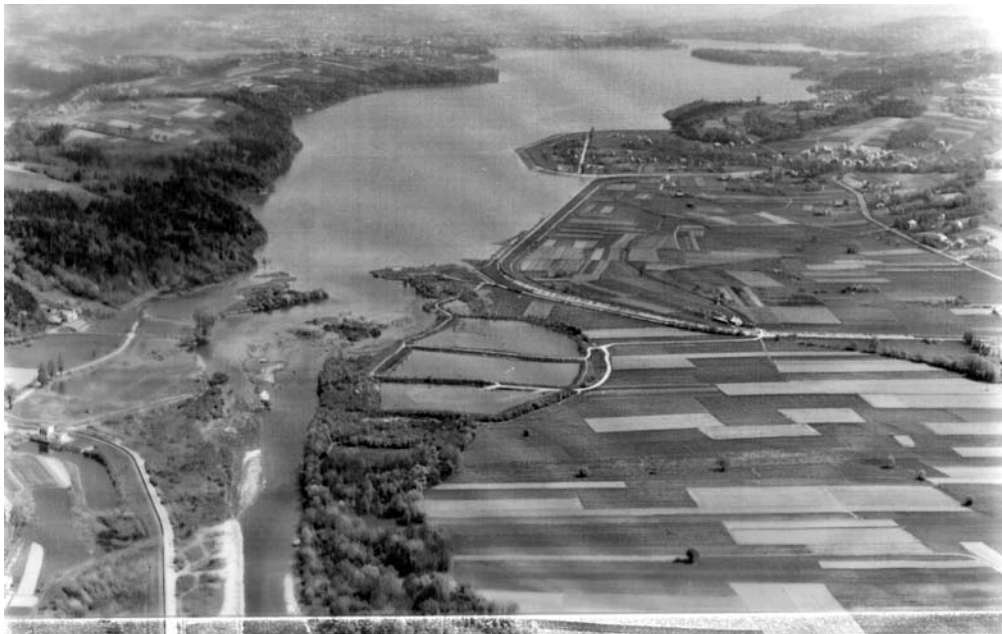
Fot. 2. Cofka zbiornika Dobczyce na rzece Rapie. Okres eksploatacja ponad 10 lat. Główne zadania: zaopatrzenie w wodę Krakowa, ochrona przed powodzią. Widoczne zapory boczne, przepompownie wód, wypływanie max. o ok. 4 m. Presja zlewni własnej zbiornika. (fot. W. Gorgolewski)
