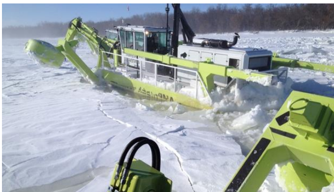
Ilustracja 50: AMPHIBEX AE450E działający jako lodołamacz ( http://www.normrock.ca/ i https://i.cbc.ca/ )
