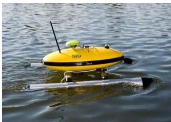
Ilustracja 57: Przykładowe modele autonomicznej łodzi pomiarowej z GPS i echolotem („Sonobot“ http://www.geo-dv.de )
