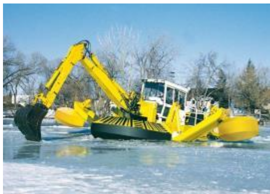
Ilustracja 50: AMPHIBEX AE450E działający jako lodołamacz ( http://www.normrock.ca/ i https://i.cbc.ca/ )
