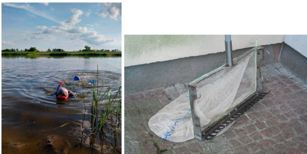
Rysunek 5.3.1.1. Pobór prób z wykorzystaniem sprzętu do nurkowania. Z prawej strony draga
